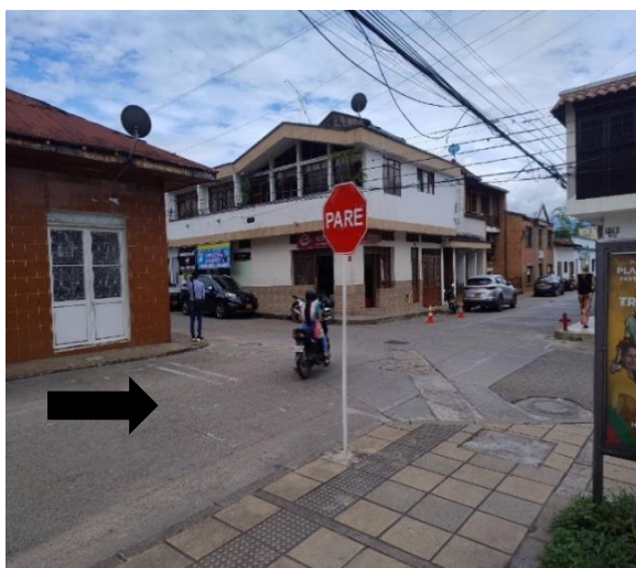
IMAGEN 11. En el sector de la calle 10 con cra 9 se ilustra la falta de señalización vial tipo horizontal SR-01, de igual forma se deberá instalar 03 reductores de velocidad plásticos con su señalización vial SP-25
