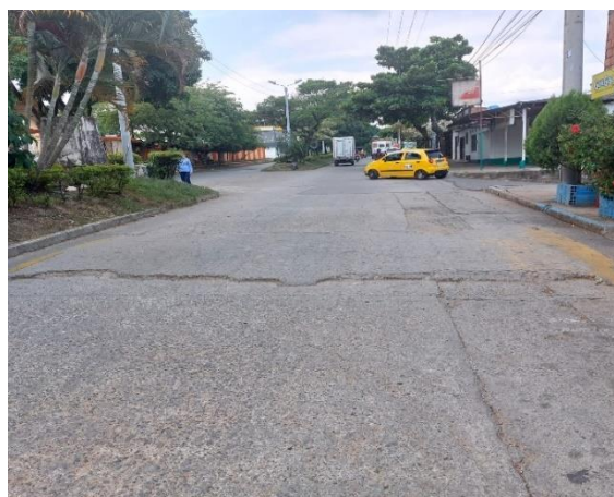
IMAGEN 59. Imagen de la calle 10 con cra 4 sector camellon donde se en cuentan instalados reductores de velocidad los cuales se en cuentan en al estado y no cuentan con señalizacion tipo vertical
